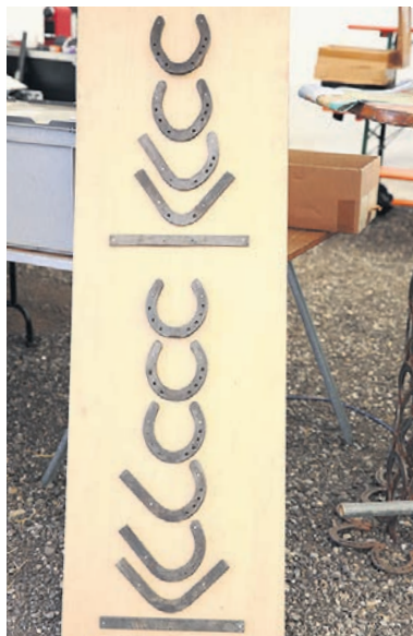
V. l.: Ein Hufeisen entsteht. Komplexe und aufwendige Handarbeit. – Die eigens gefertigten Skizzen halfen während dem Wettkampf, die richtigen Masse zu treffen. – Der Passform des Eisens wurde viel Wert zugetragen. – Reto Eggenberger bei den letzten Schläffen, kurz bevor die Zeit zu Ende war.
